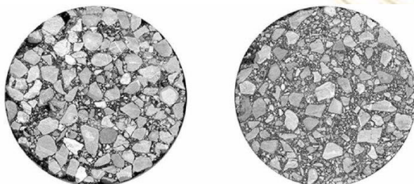
Рисунок 1 – Структура ЩМА (слева) и асфальтобетона (справа)
