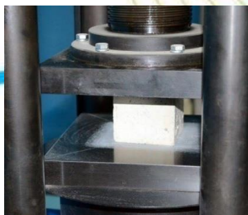
Фото 1 – Испытание самовосстановительного бетона с добавлением бактерий на прессе
