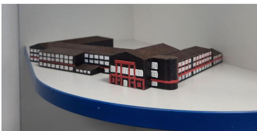
Рисунок 2 – Макет, распечатанный на 3D-принтере
